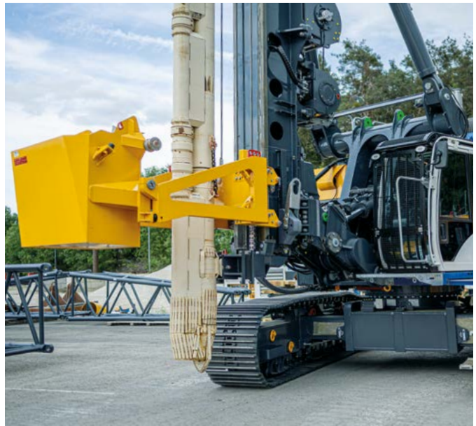
Rüttelstopfverdichtung Vibro Replacement
